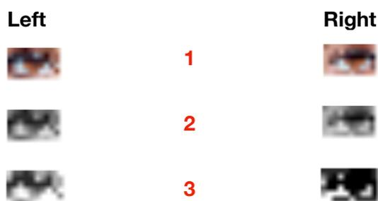
Abbildung 3. Die Augendaten werden verkleinert (1), dann in Graustufen umgewandelt (2), und anschließend wird das Graustufenbild normalisiert (3).
